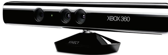
Fig. 11. Cámara RGB-D Kinect de Microsoft.
